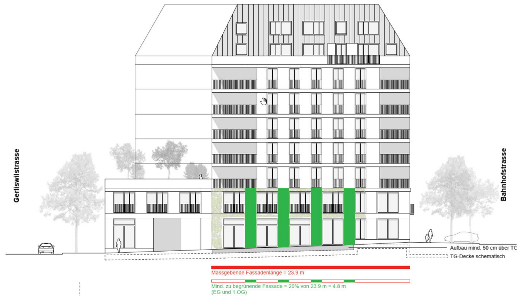
Abbildung 35: Ansicht mit geplanter Fassadenbegrünung
